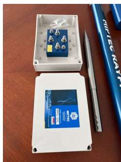
Acoplador sincronizador de admitancias y gabinete.
