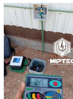
Medición final: 0.45 Ω con telurómetro digital.
